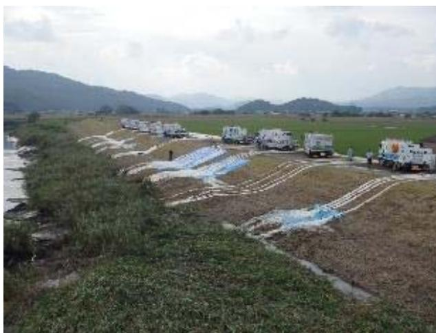
排水ポンプ車による排水作業（応急対策班）
